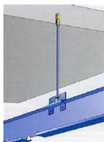
ŝraŭbtigo fiksitaj sub plafono por teni relon
