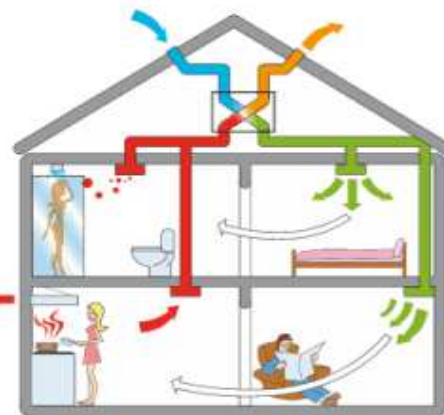
duflua ventolado (elira aero donas siajn kaloriojn por varmigi eniran aeron)
