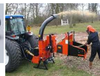
traktoroŝafto de traktoro (tie kuplita kun lignopisto)
