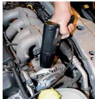
stroboskopa lampo por mezuri rotacian rapidon en revolunombro je minuto
