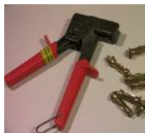
pinĉilo por ekspansieblaj ŝraŭboj
