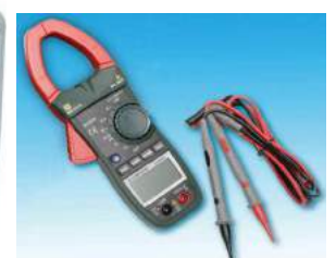
cifereca multimetro kun ampera pinĉilo kaj du kontaktpintoj
