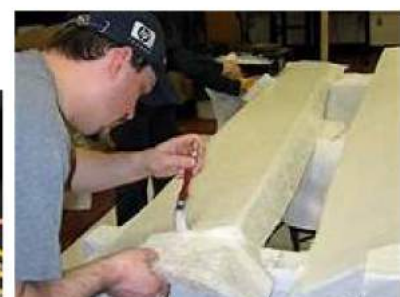
ŝmirado de vitra fibro per rezino
