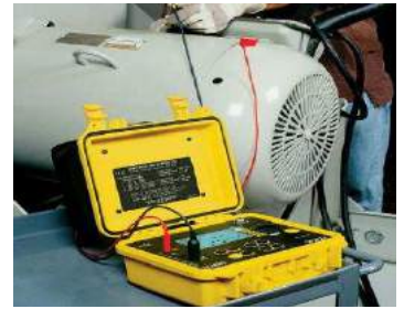
kontroli izolrezistancon de motoro per megommetro
