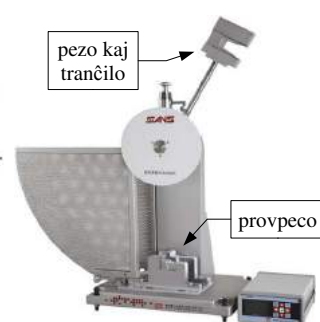
detruiga provo de fleksio per kolizio (maŝino de Mouton-Charpy)
