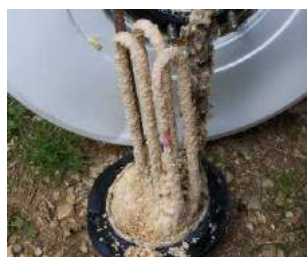
kalka deponaĵo en akvohejtilo
