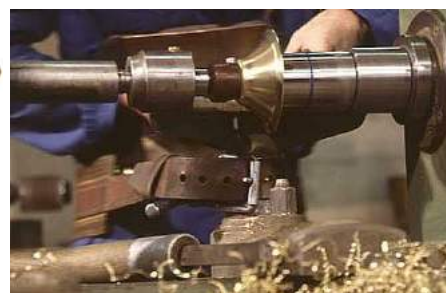
mandreno por retropuŝi latunan ladon sur tornilo
