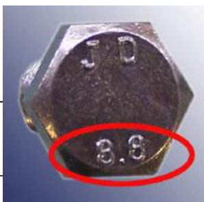
stampo sur ŝraŭbkapo : cedlimo = 8 (80 kg/mm²) elastolimo = 80% (64 kg/mm²)
