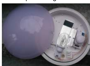
movdetektila lampo per altfrekvenco (lampo de la kastelo Greziljono)
