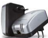
du konektiloj por krei elektroreta komunikiĝo (elsendilo kaj ricevilo)
