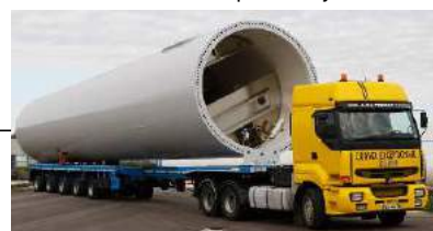
peco por masto de ventgeneratorio
