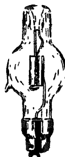
Diodo, aŭ du-elektroda aŭ rektifa valvo.
